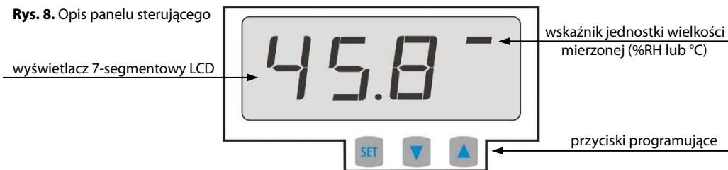
Rys. 8. Opis panelu sterującego
